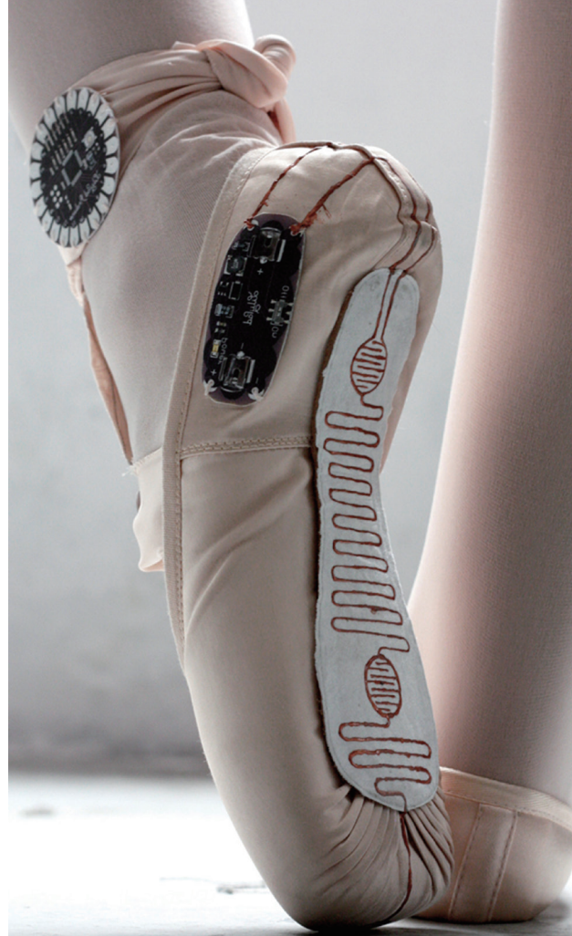
1. 발에 부착하는 신발형 디바이스 E-Traces. 신발의 바닥에 배치된 센서가 발레리나의 움직임을 분석한다.
