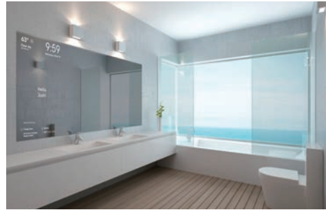
마이크로소프트가 선보인 23.6인치 LCD가 달린 반투명 스마트 거울. 매직 미러(Magic Mirror)라고 이름 지은 이 거울은 사용자를 인식한 뒤 사용자의 기분을 읽고 시간, 날씨, 이메일 등 다양한 정보를 거울에 표시한다.
