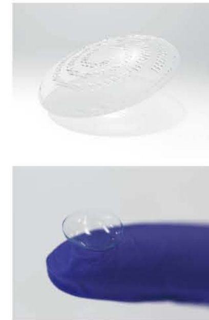
스마트 콘택트렌즈 센서는 투명하고 유연한 소재로 만들어(위), 상용화된 소프트렌즈에 장착시켜 사용할 수 있다(아래).
