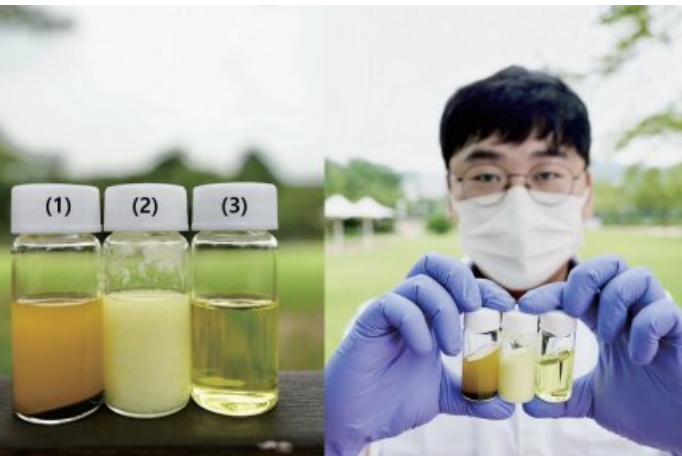
에너지화학공학과 석상일 교수팀에서 개발한 에탄올 기반 페로브스카이트 용액. 독성을 크게 줄여 상용화의 기틀을 닦았다.
